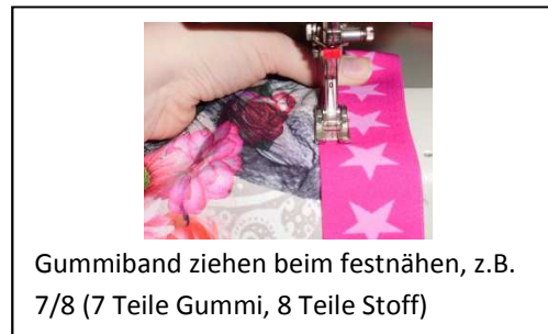
Gummi ca. 1 cm vom oberen Rand platzieren, ca. 1 cm hinter der Markierung
